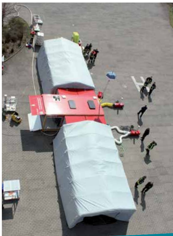
Aufgebauter Abrollbehälter Dekon-V mit Zeltvorbau
