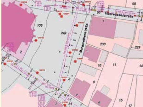
Gemeinsame Darstellung von Kanalkataster und Leuchtenkataster auf Grundlage der Liegenschaftskarte im Geoportal Wadersloh
